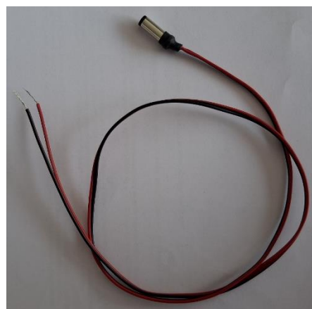
Figura 10 Inserción de la fuente de alimentación mediante conector tipo barril
