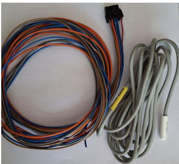
Figura 6 Conector de interfaz de I/O con conjunto de cables para sensores
